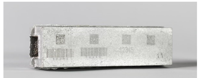
Markierungsproben auf einem Gussteil, Foto: IGCV, T. Hase
